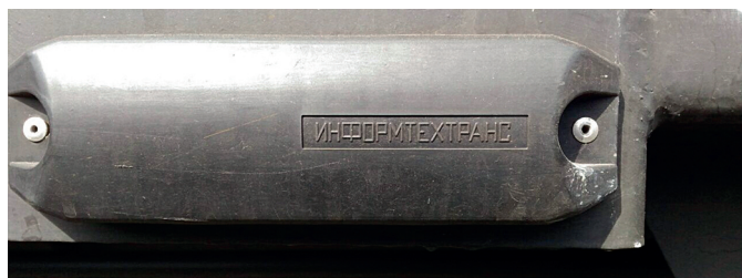
Рис. 3. RFID-метка на железнодорожном вагоне
