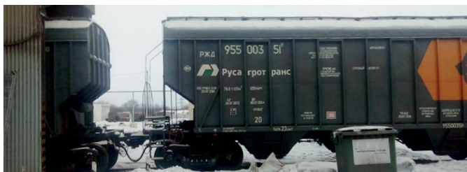
Рис. 8. Вагон-хopper для перевозки сыпучих продуктов
