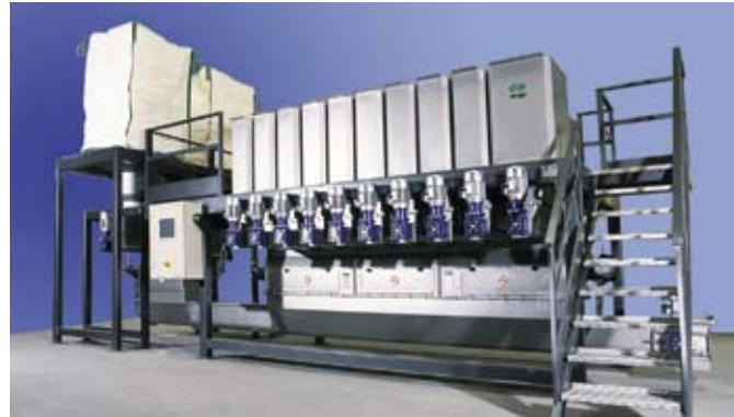
нержавеющей стали. На производстве комбикормов и премиксов иногда возникают сложности с транспортированием микрокомпонентов с частицами малых размеров, поэтому шнеки дозирования в системе «Имаго» имеют антиадгезионное пластиковое покрытие, что позволяет избегать прилипания к ним гигроскопического продукта. Углы с закругленными фасками также облегчают разгрузку шнеков и обеспечивают чистоту кожуха.
