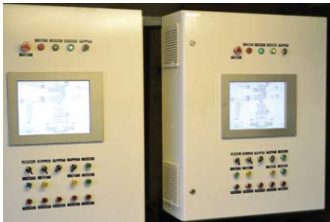
Рис. 2. Шкафы автоматики пресс-гранулятора с отображением мнемосхемы
