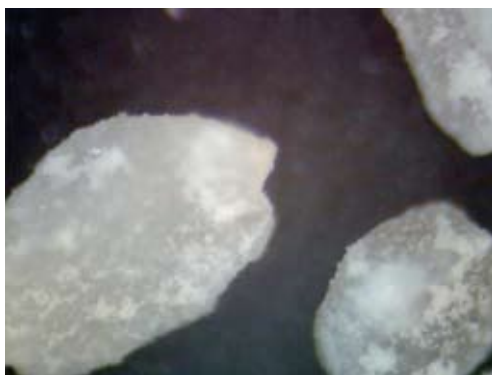
Рис. 12. Известняк: незначительное удержание активных компонентов на поверхности частиц
