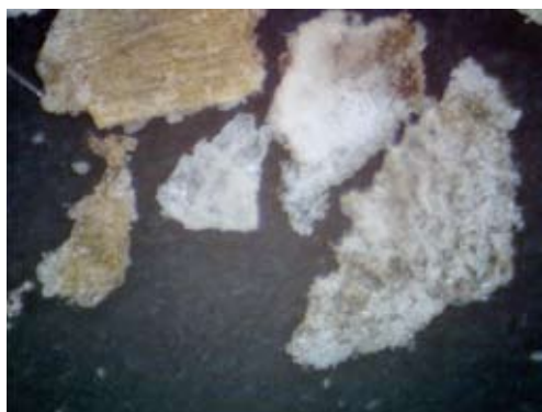
Рис. 11. Отруби: лучшее удержание активных компонентов на поверхности частиц
