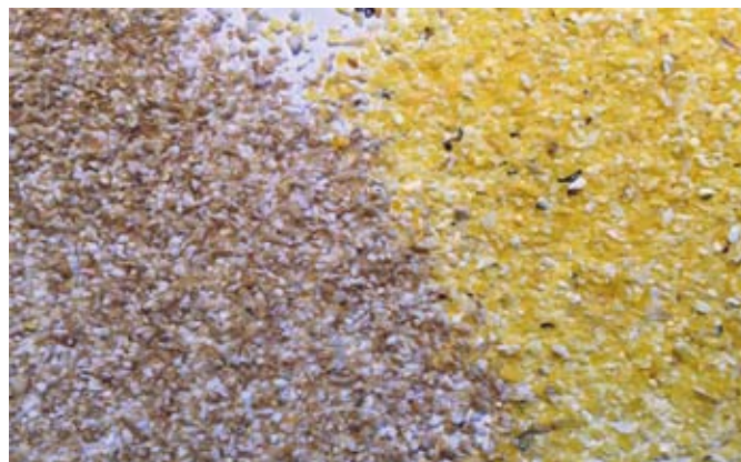
Рис. 1. Гомогенная структура зерен пшеницы и кукурузы при тонком размоле на вальцовой дробилке (размер частиц 0,75 мм)
