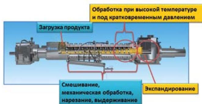
Рис. 10. Конструкция и функция экспандера
