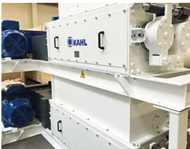
Рис. 3. Принцип измельчения на вальцах дробилки для гомогенного гранулометрического состава и двухступенчатая вальцовая дробилка
