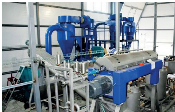
Рис. 3. Установка непрерывного производства мясокостной муки
