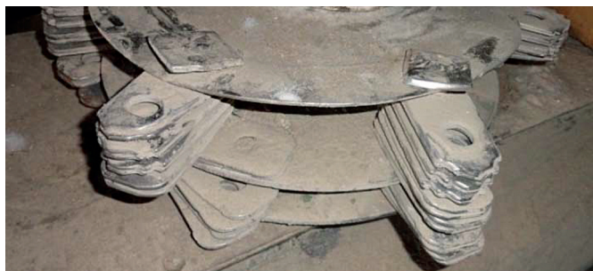
Рис. 1. Значительный износ молотков верхних ярусов в дробилке
