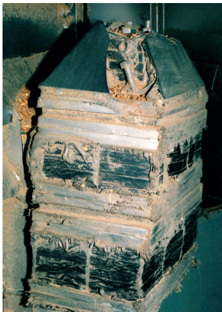
Фото 1. Износ магнитной системы из феррита бария после 17 лет эксплуатации магнитного сепаратора производительностью 50 т/ч, установленного на линии подачи зерна
