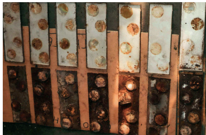
Фото 2. Износ магнитных систем из Nd-Fe-B после 6 лет эксплуатации магнитного сепаратора производительностью 50 т/ч
