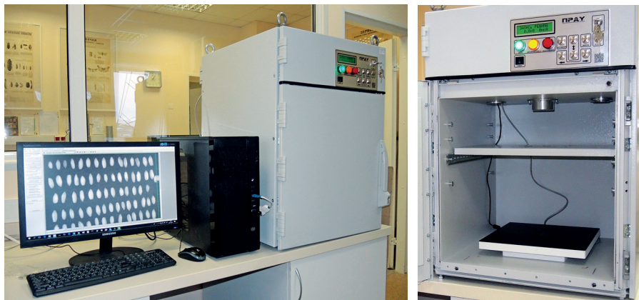
Рис. 2. Модернизированный рентгенодиагностический комплекс (сканер отсутствует)
