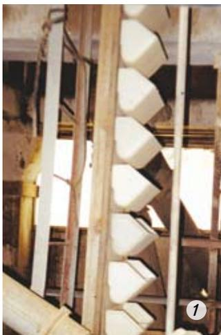
*Фото 1. Приемочные испытания на электростатическую искробезопасность полимерных ковшей для норий производительностью 175 т/ч (Набережночелнинский КХП, 1977 г.)*
