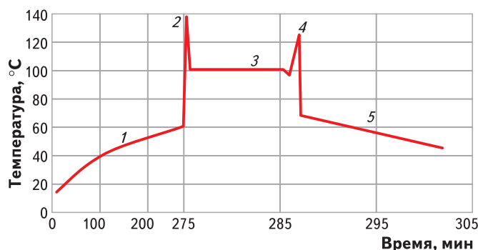
Рис. 3. Изменение температуры сои в процессе ее переработки по технологии Farmet EP1 Resu+:
