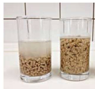
Рис. 6. Процесс набухания: слева — твердые гранулы, справа — мягкие
