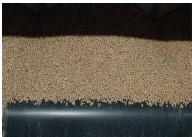
Рис. 9. Применение ленточного конвейера исключает возможность повреждения гранул во время перемещения
