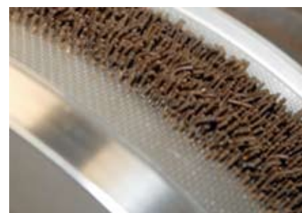
Рис. 5. Матрица пресс-гранулятора с отверстиями диаметром 2,2 мм
