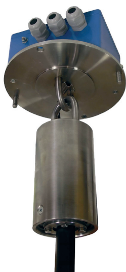
Рис. 2. Соединение ЧЭ на основе кабель-троса с шарнирным узлом подвеса в термоподвеске ТУР-01
