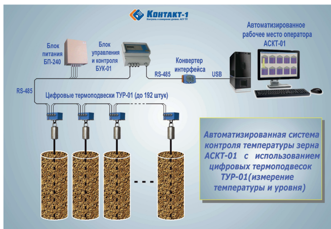
Рис. 4. Система АСКТ-01 с использованием термоподвесок ТУР-01
