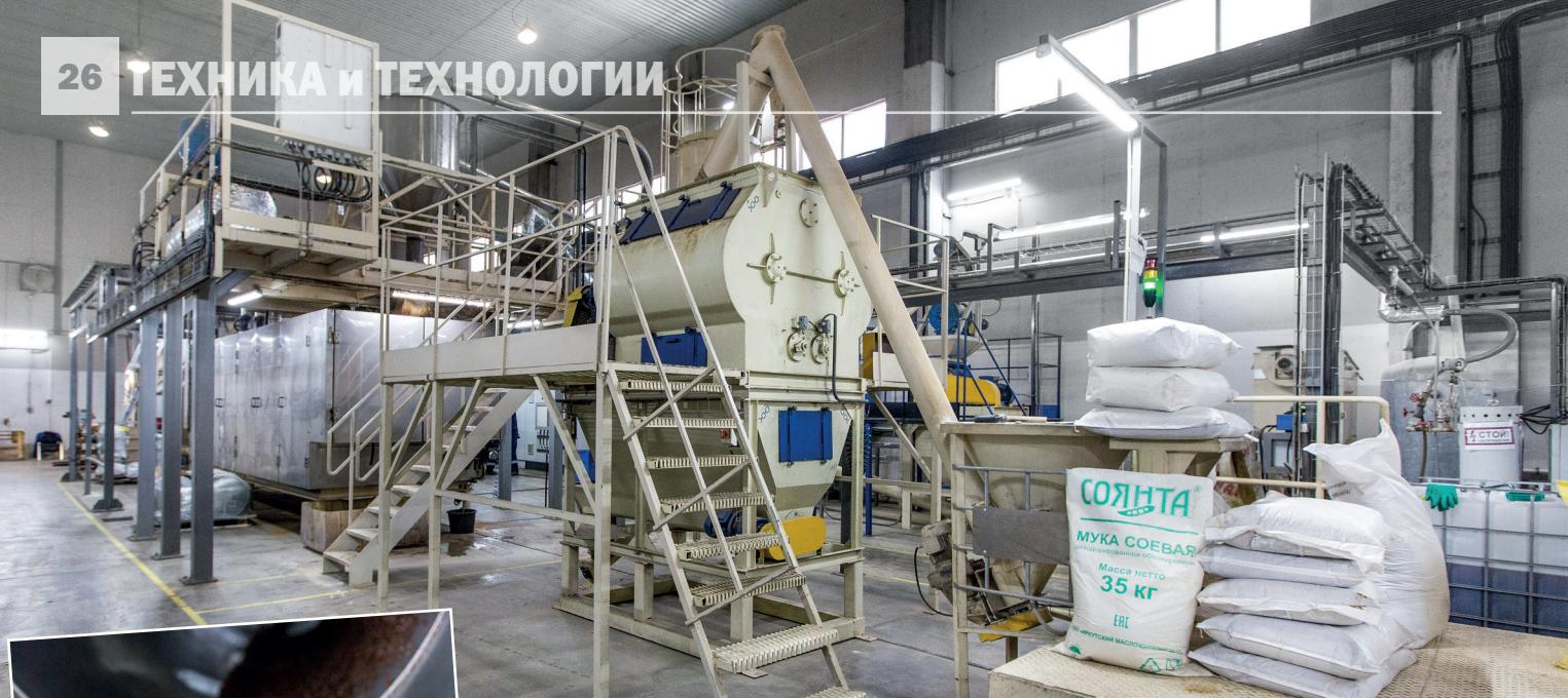
рыбных кормов: чем тоньше помол, тем выше стабильность в воде, равномернее текстура и поверхность гранулы. Измельченный продукт поступает в накопительный бункер, а далее в кондиционер, куда подаются вода, пар и жир. Здесь происходит дополнительное его смешивание, увлажнение, нагревание. Увлажнение перед экструзией необходимо для лучшей пластификации и формообразования корма.
