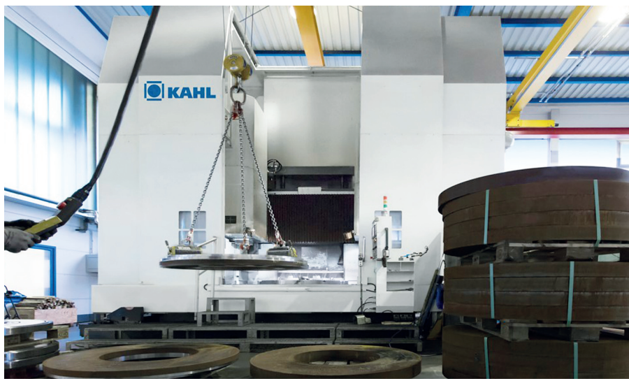
Вакуумная закалка матриц и роликов
