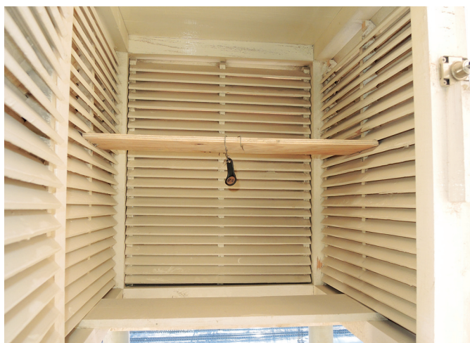
Рис. 4. Термогигрометр DS1923-F5, установленный в наружной климатической будке
