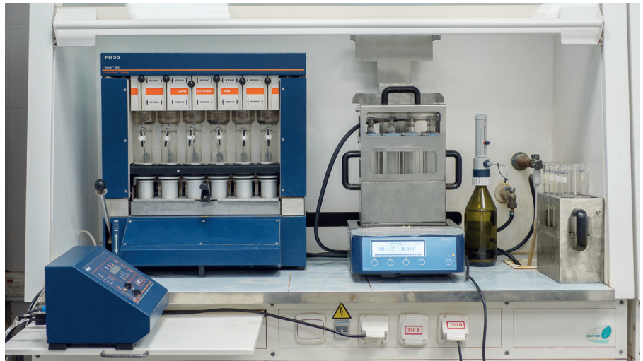
Анализатор клетчатки и дигестор для сжигания проб
