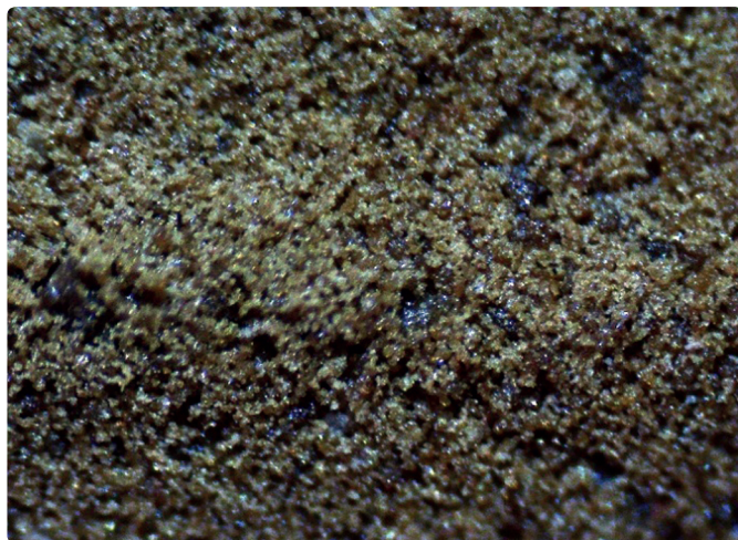
Рис. 2. Частицы стандартного оксида цинка (порошок коричневатого цвета)
