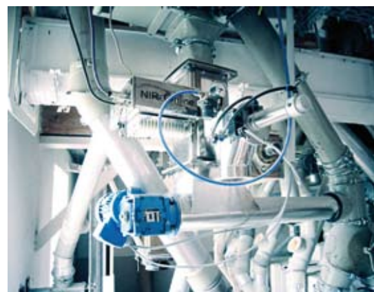
Легкая интеграция: датчик, встроенный в технологическую линию
