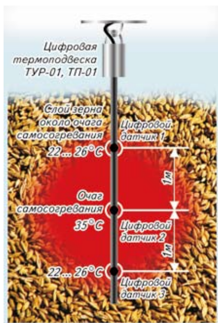
Рис. 10. Расположение термоподвески в силосе
