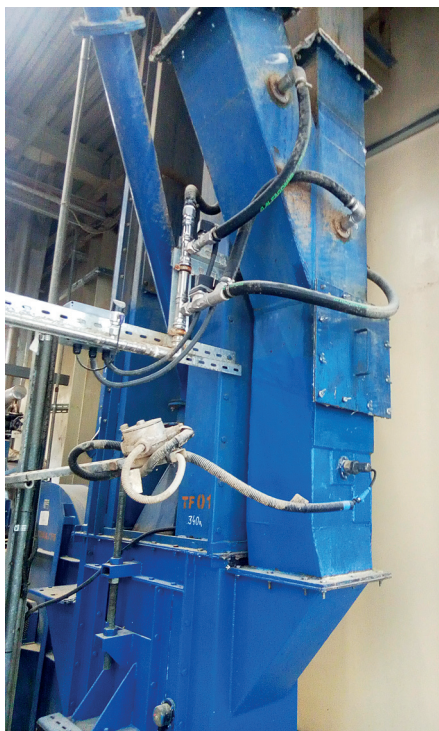
Рис. 4. Вариант установки форсунок на оборудовании для подачи добавки в продукт
