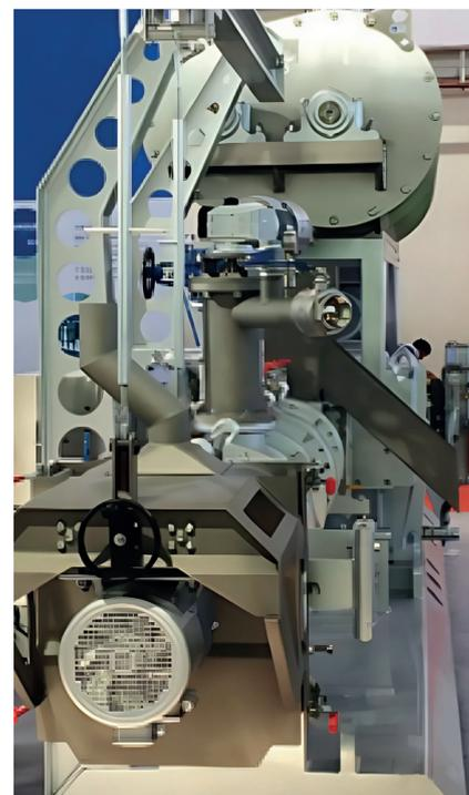
Рис. 4. Корпус экструдера с загрузочным шнеком и вакуумным отверстием
