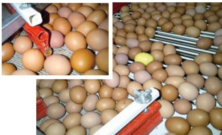
Рис. 5. Большое количество соударений с выступающей частью направляющей планки
