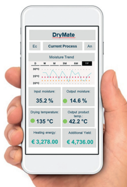
Рис. 8. Функция автоматического контроля влажности DryMate
