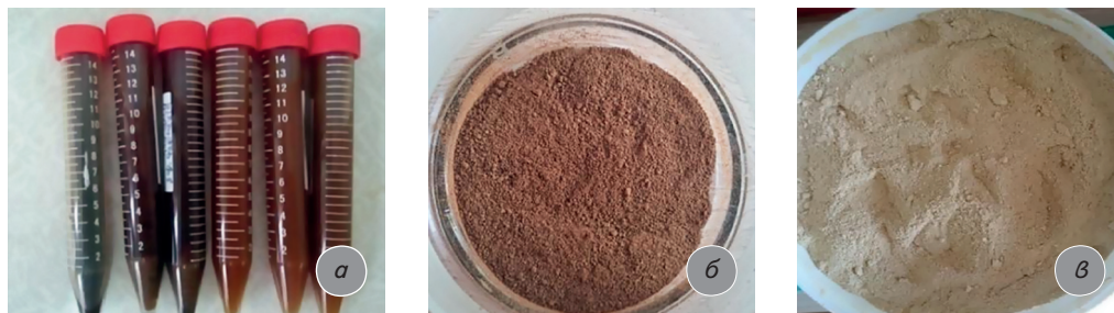
Рис. 1. Внешний вид гидролизата из отходов переработки пресноводной рыбы:
