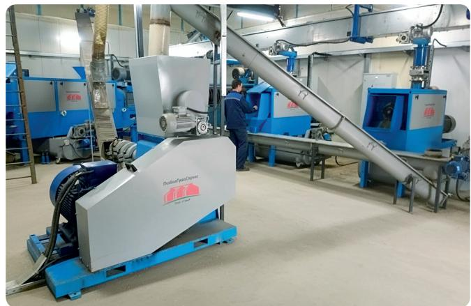
рушально-веечное оборудование применяется при переработке семян рапса, льна или конопли. Для обеспечения работы экструдера в оптимальном режиме и однородности соевого экструдата соевые бобы предварительно измельчают в дробилке. В зимнее время и при температуре семян масличных культур менее 15°C их сначала нагревают в нормализаторе горизонтального типа или в бункер-нагревателе до температуры около 30°C, затем подают на переработку и в форпресс.
