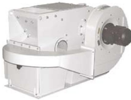
Воздушный поток, создаваемый вентилятором, отклоняет поток поступающего продукта. Тяжелые примеси отделяются и удаляются через открывающуюся с помощью пневмопривода заслонку.
