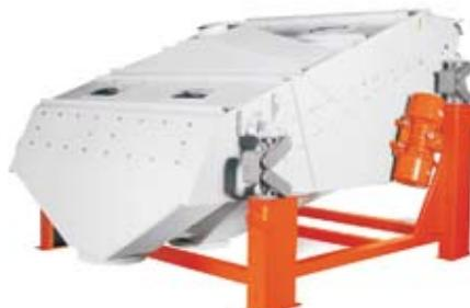
**Просеиватели с неподвижным барабаном** обеспечивают высокоэффективную очистку сухого сыпучего материала и материала с низкой сыпучестью на предприятиях зерноперерабатывающей промышленности, в том числе комбикормовой.
