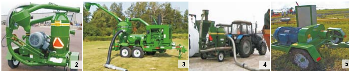
Рис. 2. Пневмоперегрузатель Walinga с электродвигателем
