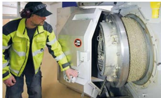
**Низкие эксплуатационные затраты.** Грануляторы типов С и CU фирмы Van Aarsen обеспечивают производительность до 60 т/ч, в зависимости от различных параметров. Они отличаются низкими эксплуатационными затратами на тонну корма, даже до 1 евро, включая затраты на матрицы, ролики и изнашивающиеся части.
