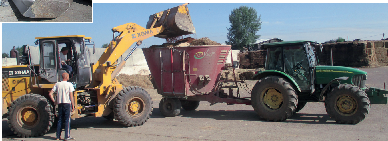
Рис. 1. Приготовление кормовой смеси (монокорма) в мобильных измельчителях-смесителях (ООО «Агрофирма «Заря», Нижегородская область)
