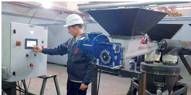
Рис. 2. Испытания новой линейки дозаторов и систем управления комбикормовых заводов на производственном комплексе «Доза-Агро»
