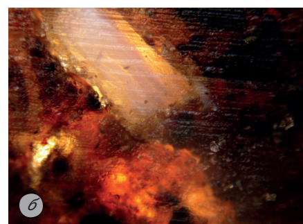
Рис. 3. Фотографии поперечного сечения экструдированных гранул комбикорма для радужной форели: а — нанесение жира методом дражирования; б — вакуумное напыление жира (при P = 0,02 МПа)
