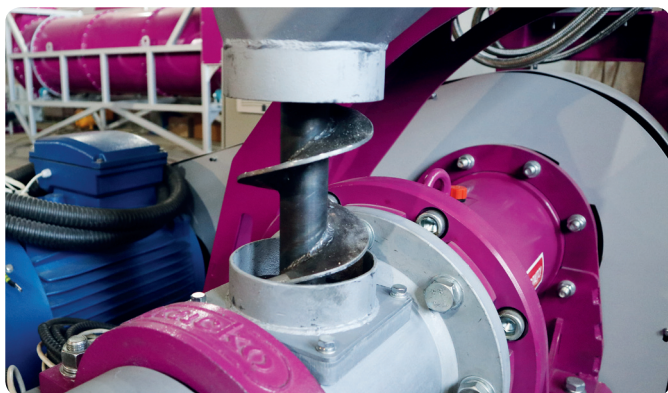
Вертикальный питатель равномерно подает сырье в ствол экструдера
