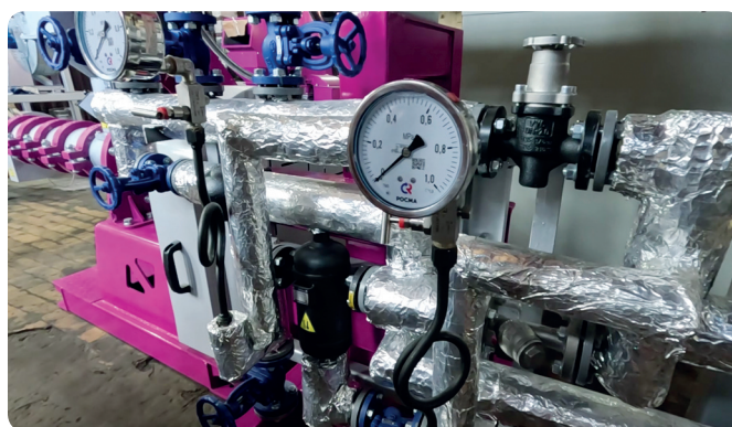
Блок паровой обвязки готов к работе: собран, опрессован и термоизолирован
