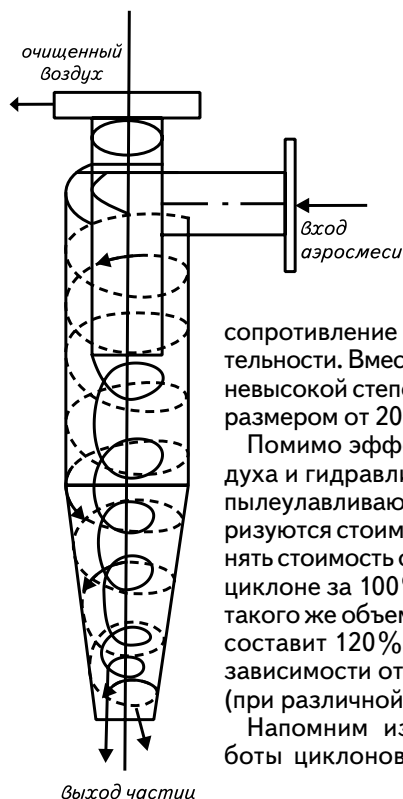
Рис. 1. Винтовые потоки в циклоне:
