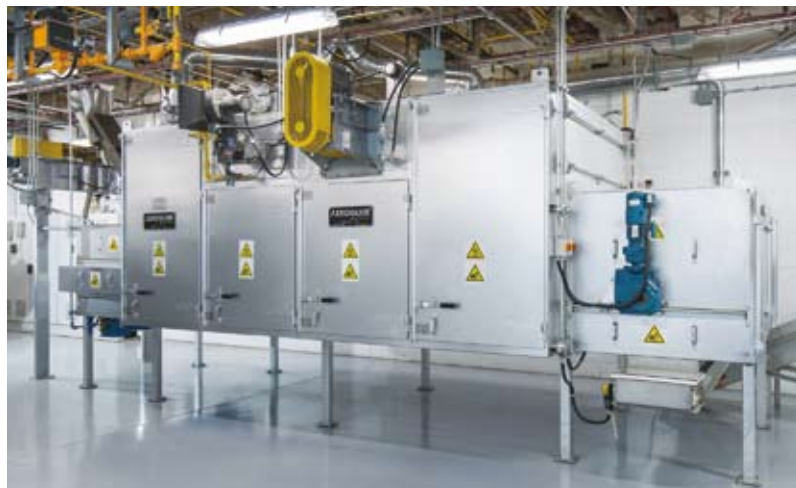
Ленточная сушилка AeroDry™ удаляет остаточную влажность из экструдированных продуктов
