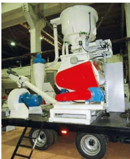
**Рис. 1.** Установка с горизонтальным смесителем
