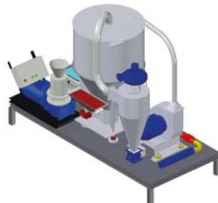
**Рис. 4.** Вариант стационарной блочной установки для производства гранулированных комбикормов
