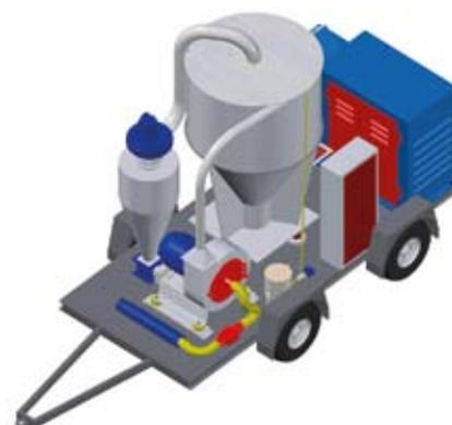
**Рис. 2.** Передвижная установка с вертикальным смесителем-дозатором и с дизель-генератором
