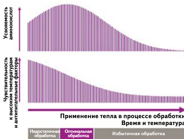
Рис. 7. Схема воздействия тепловой обработки на усвояемость аминокислот и на антипитательные факторы в соевом шроте
