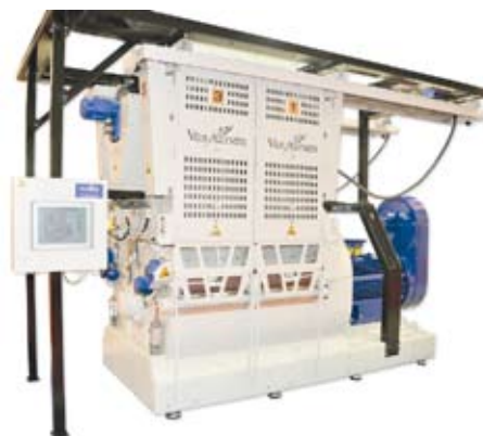
Молотковая дробилка GD1400 с автоматической системой замены сит
