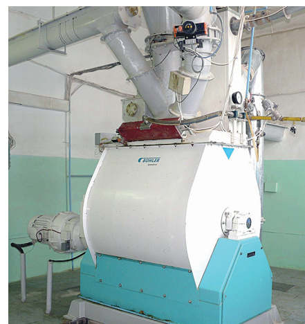
Рис. 4. Скоростной смеситель DFML-1000
