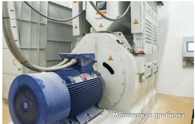
Для отбора ненужной фракции, способной повредить рифли, перед этим станком установлен просеиватель. Приводы мощностью свыше 15 кВт не только молотковых дробилок, но и всего оборудования на этом заводе оснащены энергоэффективными электродвигателями с частотными контроллерами. ➔
