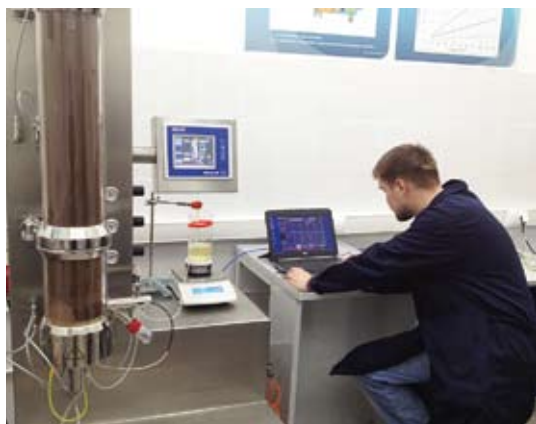
Рис. 5. Микрогранулирование компонентов кормовой добавки
