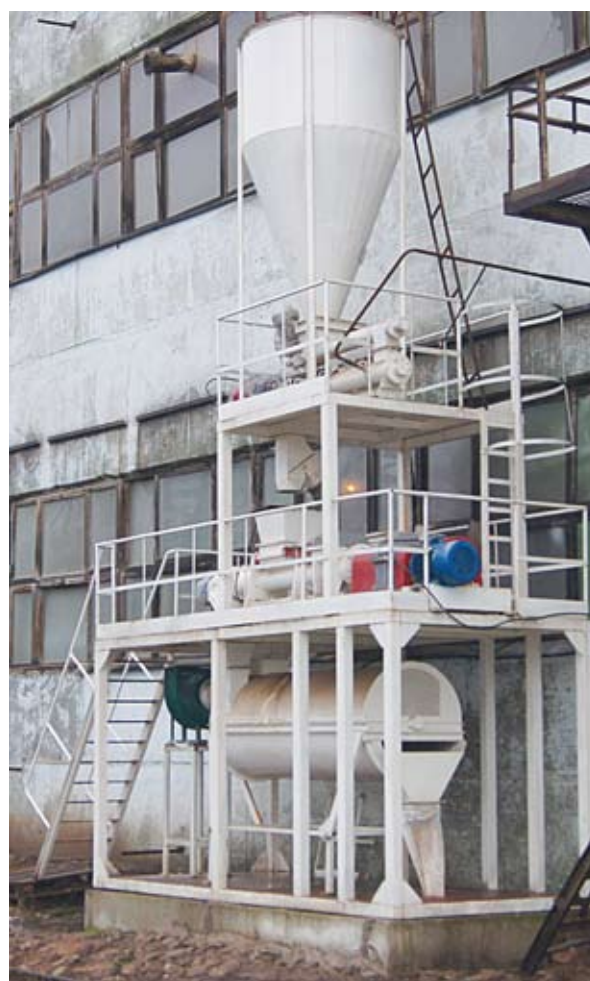
Рис. 4. Линия влажного прессования кормовых концентратов с повышенным содержанием мелассы
