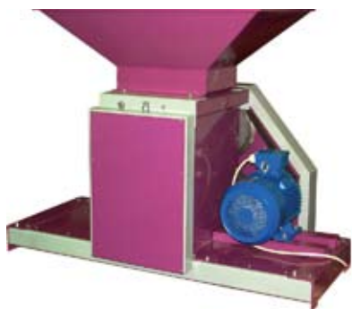
Дробилка вальцовая с регулируемой фракцией измельчения
