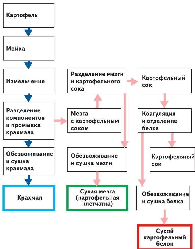
Рис. 3. Схема производства картофельного крахмала с получением сухих побочных продуктов
