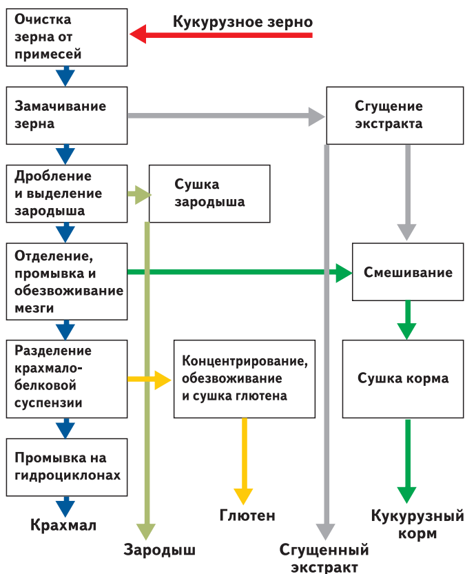
Рис. 1. Схема переработки кукурузного зерна на крахмал и побочные продукты
