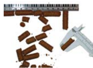
Рис. 2. Измерение длины и диаметра гранул линейкой и штангенциркулем
