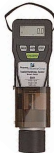
Рис. 4. Цифровой прибор для измерения твердости гранул
