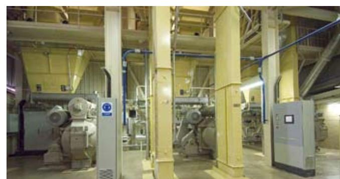
ния продукта при его чрезмерном скоплении в рабочей камере; муфтой сцепления, останавливающей работу пресса в случае перегрузки основного вала; подъемным устройством для замены матрицы; системой автоматической смазки основного вала и валов двух роликов. Все части оборудования, непосредственно контактирующие с продуктом, изготовлены из нержавеющей стали.
