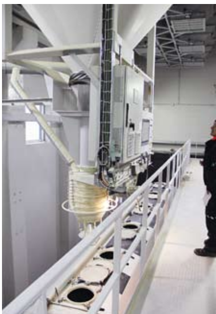
На фото сверху вниз: распределительная установка; передвижная весодозирующая система производительностью 40 т/ч; загрузка комбикормов в автотранспорт
