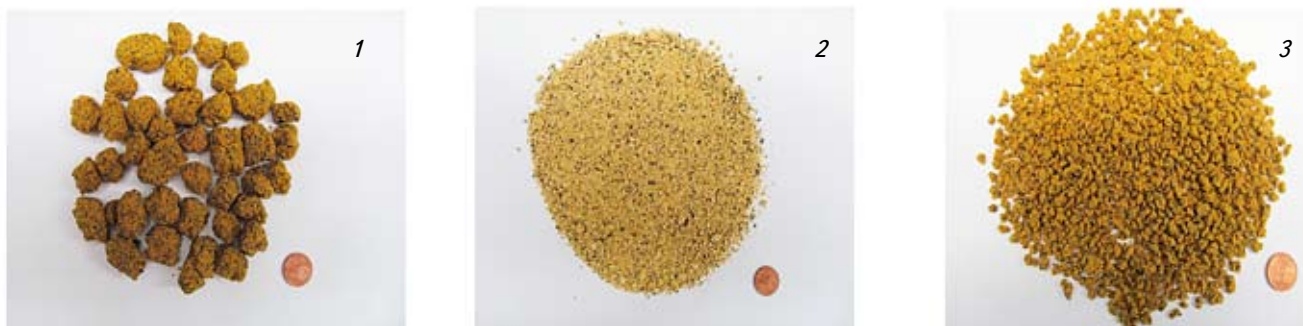
Рис. 4. Внешний вид рапсового шрота: гранулированного (1), перед извлечением из него масла; экстракционного шелушеного (2); экстракционного экструдированного (3)
