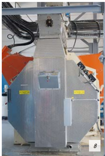
6 — термошнек; 7 — измельчитель (сверху на площадке) и просеиватель (внизу на полу); 8 — пресс-гранулятор
