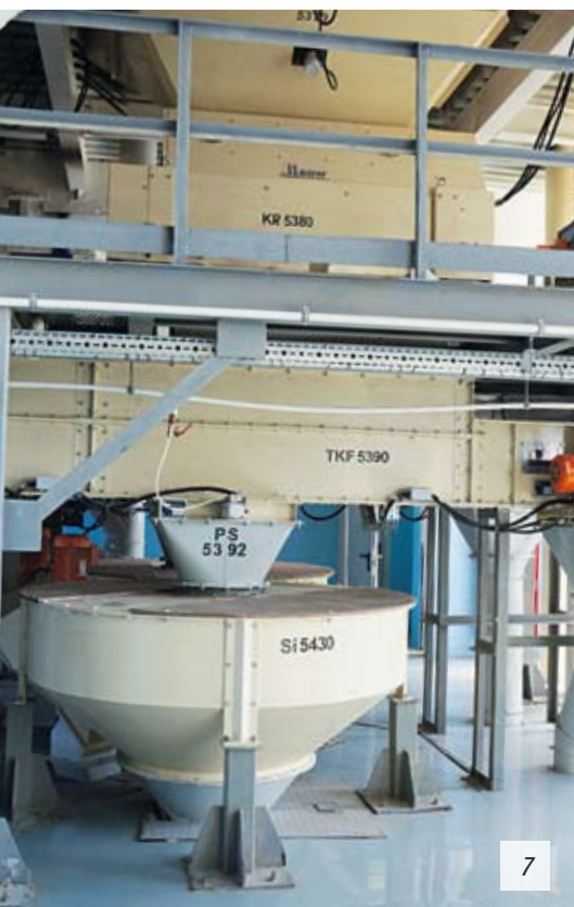
6 — термошнек; 7 — измельчитель (сверху на площадке) и просеиватель (внизу на полу); 8 — пресс-гранулятор
